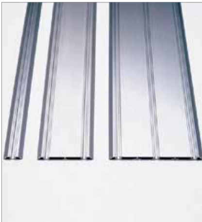
1-läufige, 2-läufige oder 3-läufige Bodenschienen können auf den Fußboden geklebt oder eingelassen werden. Für Holzfußböden oder Teppichböden sowie zum Einlassen in Fliesen oder Steinböden sind spezielle Varianten erhältlich. 1-way, 2-way or 3-way floor tracks can be glued or inserted into the floors. For wooden floors or carpeted floors, and special variants are available for insertion in tiles or stone floors.
