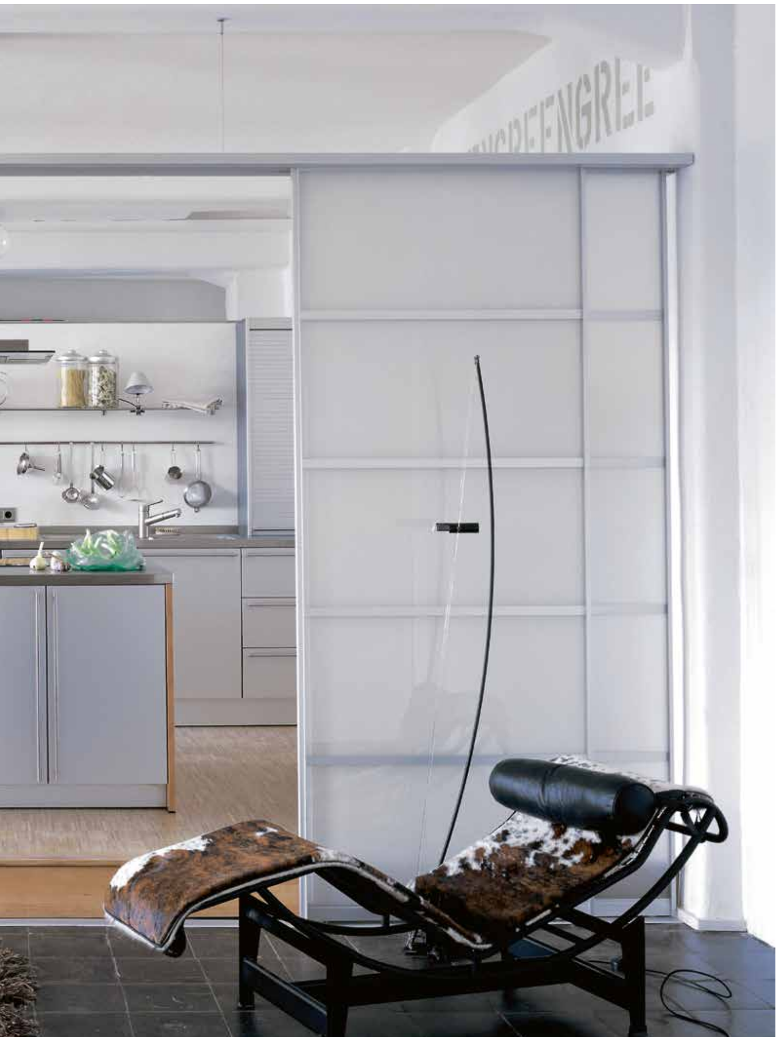
PUR Classic - Türfüllungen aus Verbundsicherheitsglas mit hellmatter Folie und Alu-Dekorleisten - Rahmen in Aluminium eloxiert - Deckenschiene abgehängt
