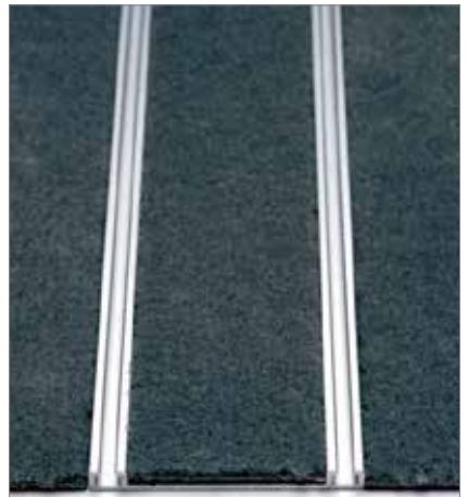
1-läufige, 2-läufige oder 3-läufige Bodenschienen können auf den Fußboden geklebt oder eingelassen werden. Für Holzfußböden oder Teppichböden sowie zum Einlassen in Fliesen oder Steinböden sind spezielle Varianten erhältlich. 1-way, 2-way or 3-way floor tracks can be glued or inserted into the floors. For wooden floors or carpeted floors, and special variants are available for insertion in tiles or stone floors.
