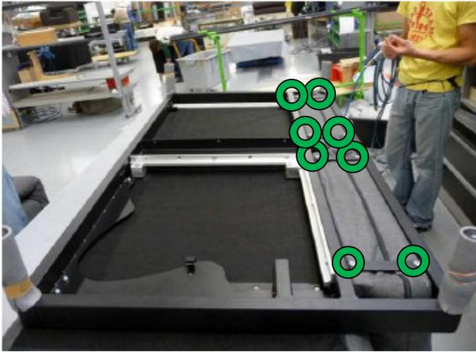
Der Rücken wird mit 4 Schrauben pro Rücken befestigt
