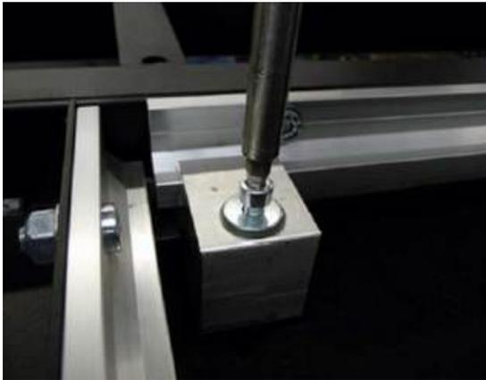
am Schlitten Schrauben entfernen
